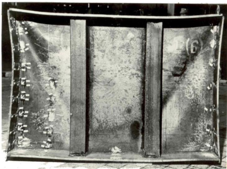
Рис. 4.17. Фрагмент балок с одной (а) и двумя (б) парами ребер жесткости стенки после испытания
